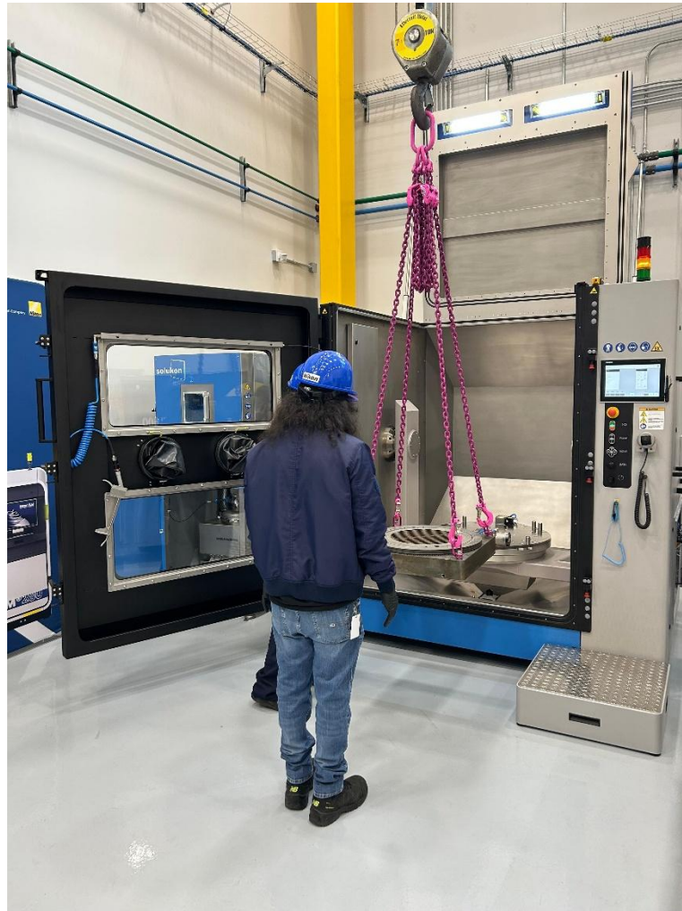
Die Beladung der SFM-AT1500-S per Kran.
