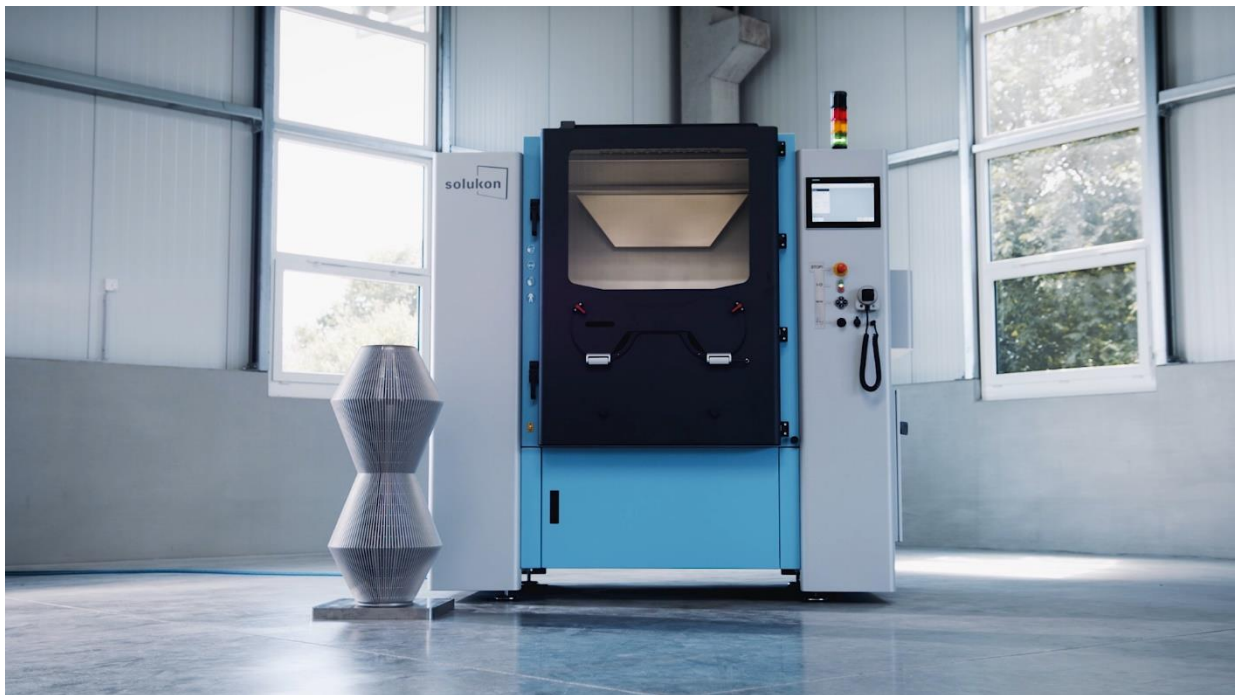
Abbildung 1: Launcher setzt beim Entpulvern auf die Solukon SFM-AT1000-S
