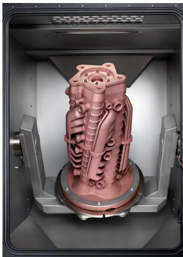
Abbildung 3: Die SFM-AT1000-S ist für besonders große Bauteile bis 800 kg ausgelegt.
