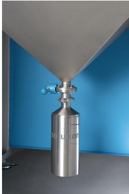
Abbildung 3: Die Schnittstelle am Pulverauslass ist mit Standard-Containern kompatibel.
