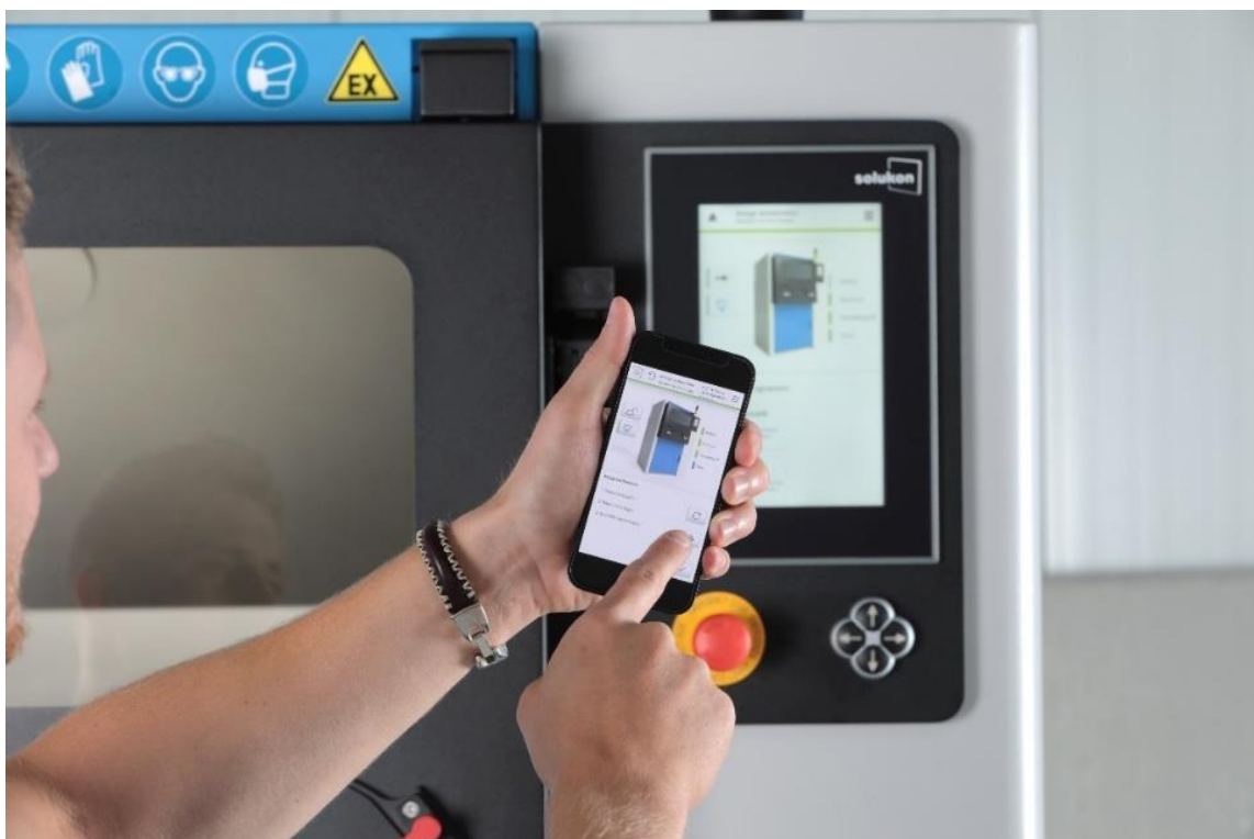
Abbildung 2: Per Smartphone lässt sich der gesamte automatische Entpulverungsprozess überwachen.
