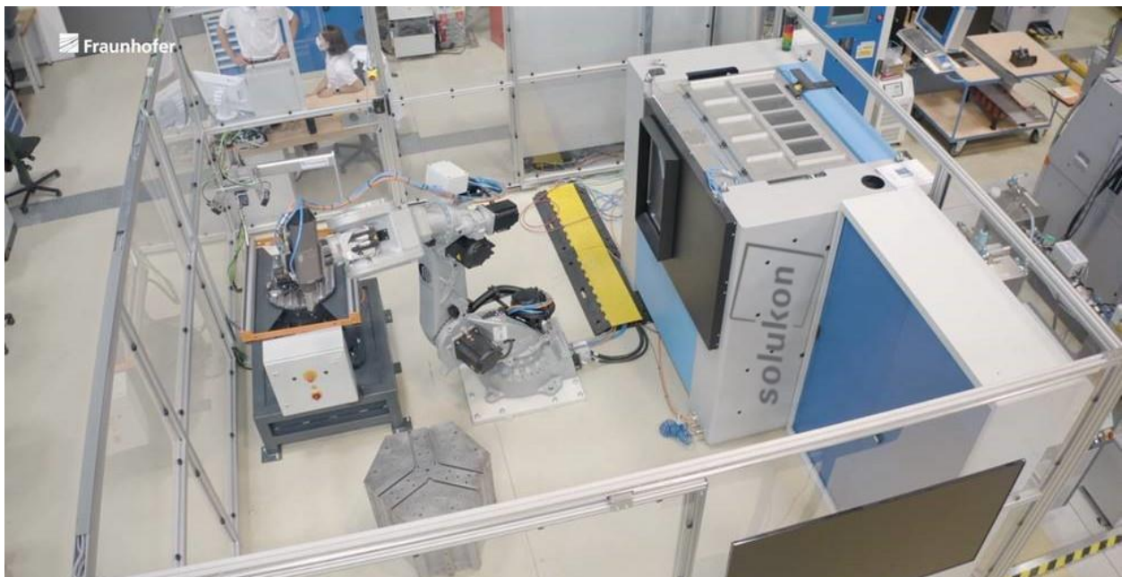
Abbildung 2: Das Solukon System in der modularen Roboterzelle bei Fraunhofer IWU. Bildquelle: Studio36 Berlin
