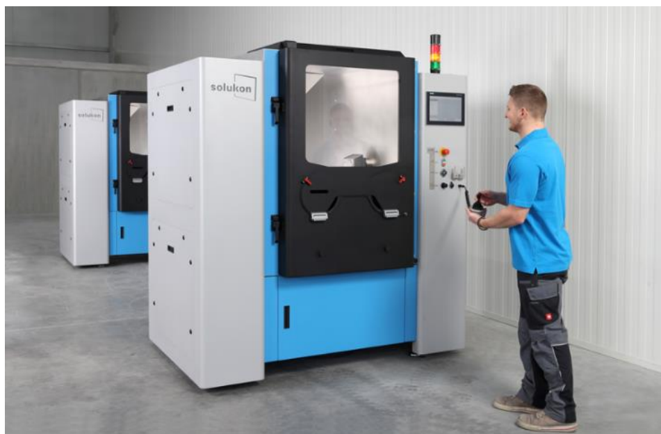
Abbildung 1: Mit dem Joystick, hier bei einer SFM-AT-1000-S, kann der Anwender das Bauteil in jede beliebige Richtung bewegen.
